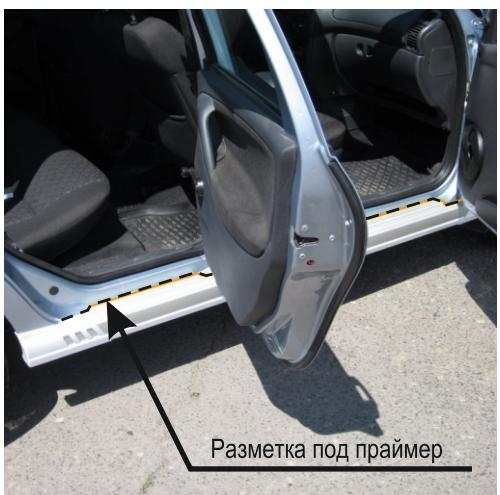
7. Демонтировать порог. С обратной стороны порога отклеить по одному концу красной защитной ленты - лайнера по 3-4см со всех частей липкой ленты, таким образом, чтобы загнув их во внешнюю сторону порога, получились выступающие язычки. Язычки лайнера необходимо загнуть и прижать, сделав складку, чтобы они не вернулись внутрь порога.
