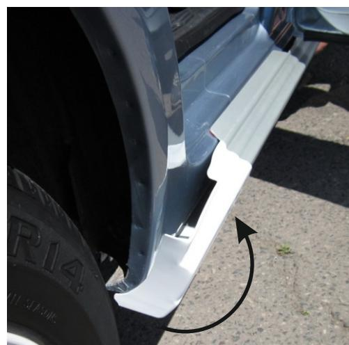
4. Далее необходимо выполнить разметку под приклейку защитной ПУ пленки на кузов автомобиля в местах контакта с пластиковыми обтекателями порога. Для этого используется бумажный скотч. Скотч наклеивается с отступом 3-5 мм от верхней кромки переднего и заднего обтекателей порога.
