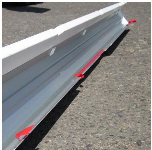
8. Обработать поверхность кузова автомобиля в местах прилегания липкой ленты праймером. Поверхность кузова перед обработкой должна быть чистой и сухой. Любые загрязнения, даже такие как отпечатки пальцев, являются барьером между адгезивом и субстратом и приводят к значительному ослаблению адгезионной связи. Праймер наносится тонким слоем кисточкой, которая находится в крышке тюбика с жидкостью. Перед приклейкой праймер на кузове должен полностью высохнуть.
