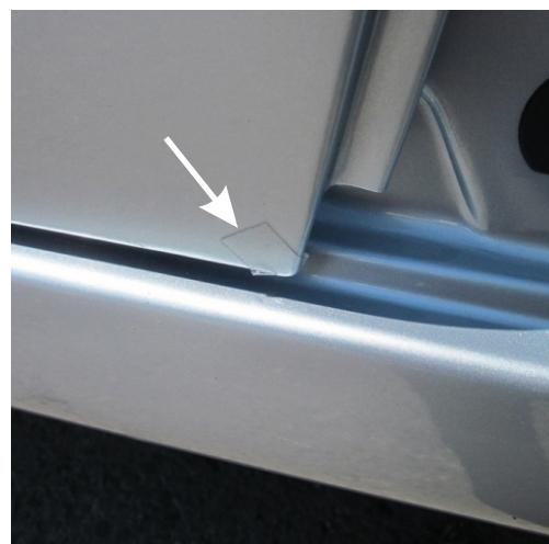
3. Выполнить предварительную установку порога на автомобиль. Данную процедуру удобнее производить вдвоем. Двери автомобиля должны быть максимально открыты. Порог подводится снизу под дверями. Ориентация по длине осуществляется по арке заднего колеса и фланцу порога.
