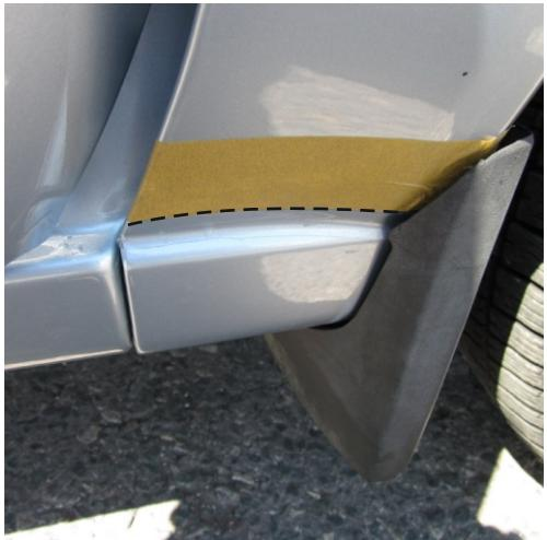
6. Повторно установить порог как было описано выше. Проверить правильность наклейки ПУ пленки. Определить места контакта двусторонней липкой ленты с кузовом автомобиля, и при необходимости выполнить разметку бумажным скотчем. Это необходимо для обработки кузова праймером, перед приклейкой порога. После обработки праймером, разметочную ленту необходимо удалить.
