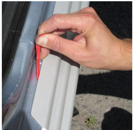
12. Прижать с усилием порог к поверхности кузова вначале руками. Затем наложить заготовленный картон, придая ему изгибы порога, зафиксировать его бумажным скотчем и закрыть двери. Для достижения наилучшего сцепления, двери необходимо держать закрытыми не менее 30минут. Обтекатели в местах приклейки липкой ленты также необходимо прижать руками с достаточным усилием.
