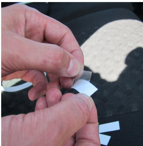
2. Открыть полностью двери автомобиля. Отделить защитную ПУ пленку от подложки, наклеить данные кусочки пленки на нижние внутренние углы передних и задних дверей автомобиля (углы, которые находятся под петлями дверей). Это необходимо для защиты ЛКП дверей и поверхности порога от случайных повреждений при монтаже. После установки порога данные элементы можно удалить.
