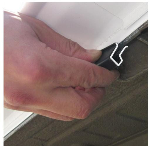
14. Закрепить задний обтекатель порога в арке заднего колеса. Для этого выполнить по два отверстия диаметром 3мм совместно во фланце обтекателя и арке колеса, плотно прижав обтекатель к кузову. Закрутить в получившиеся отверстия локерные саморезы.
