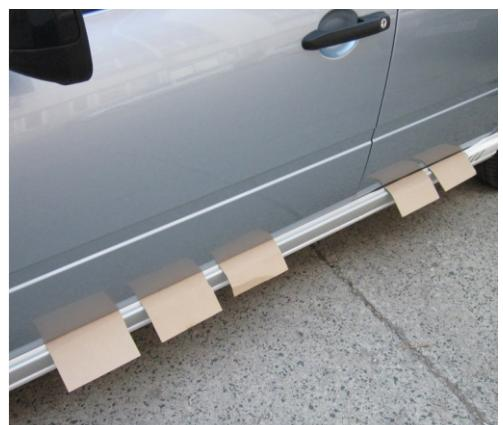
13. Закрепить порог на ребре жесткости кузова, установив по нижнему фланцу порога скобы, равномерно распределив их по длине.
